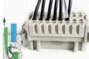
Step 3: 取出螺丝起子，弹片收回原位，从而夹紧插入的导线。
