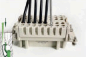
Step 1: 螺钉起子插入正方形插孔中，弹片被推向一侧，从而打开接线口。
