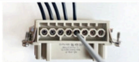
Step 4: 连接完成，请拉动导线以确认导线确实被弹片夹紧。
